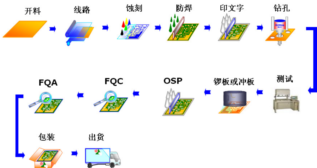
图 2.2.7-37 金属基线路板生产工艺流程图示意图
